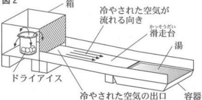
注 箱の中が見えるように、箱の側面と上面には透明な板を用いた。
